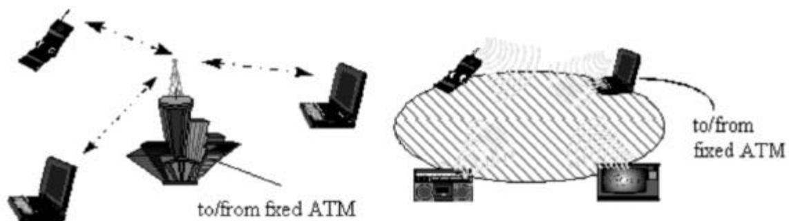
Abbildung 6.3-1 BS und Ad-hoc basierte Verbindung [ATMmobil-Projekt]
